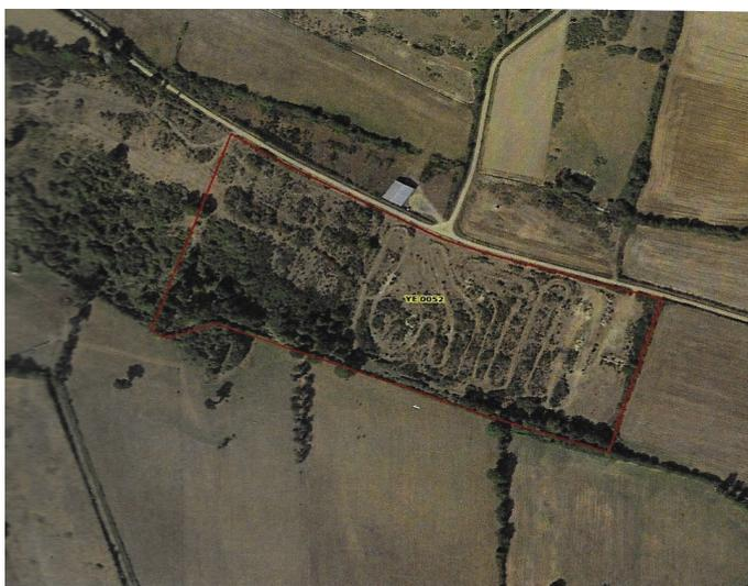
Le projet de centrale solaire prévoit l'installation de 524 tables fixes de 18 panneaux chacune, orientés au sud. Les tables, parallèles, seront positionnées à 0,8 mètre du sol, le haut des panneaux sera à 2,5 mètres de hauteur. La surface totale projetée des panneaux sera de 24 157 m<sup>2</sup>.
